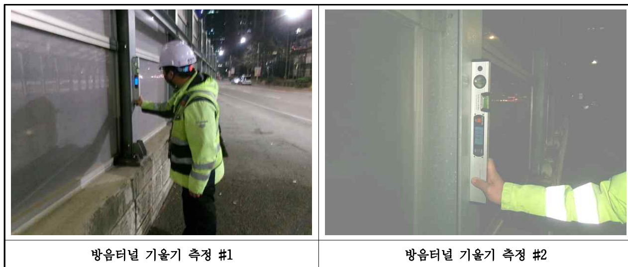
【사진 3.6.3】 경사계를 이용한 기울기 측정 현장사진
