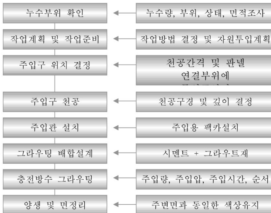
【그림 6.3.10】 충전주입방수 공법의 시공순서도
